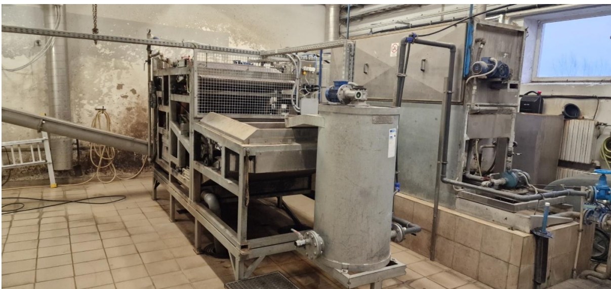
2 pav. Demontuojamas filtrpresas
